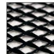
DRENTEX MAILLE est un géocomposé pour drainage, constitué d'une grille rhombique tridimensionnelle, noire, en polyéthylène, recouverte sur une face d'un filtre non tissé de filament continu suivant un procédé de laminage thermique.
