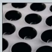
DRENTEX PROTECT 500 est une feuille de polyéthylène de haute densité (HDPE) formée de nodules semi-coniques de 20 mm de hauteur pour 40 mm de diamètre, spécialement conçue pour le drainage de flux importants d'eau.
