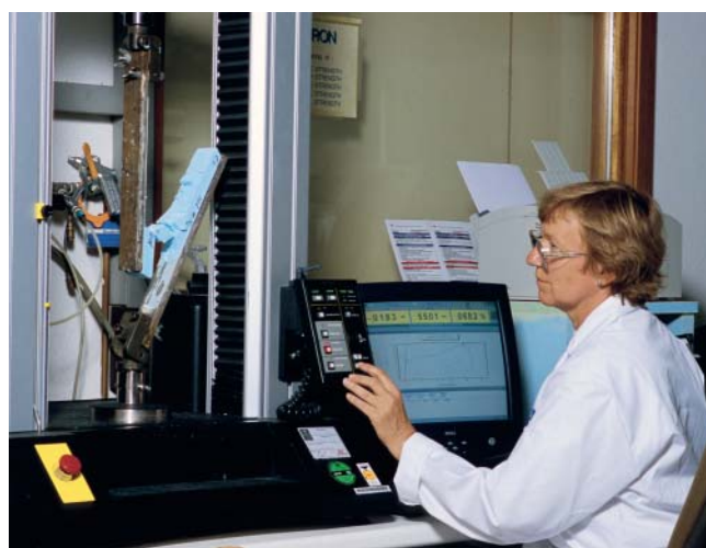
Fig. 11 Test di taglio su STYROFOAM
