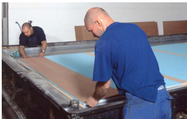
Fig. 8 Dopo aver applicato l'adesivo si procede con il rivestimento in legno.
