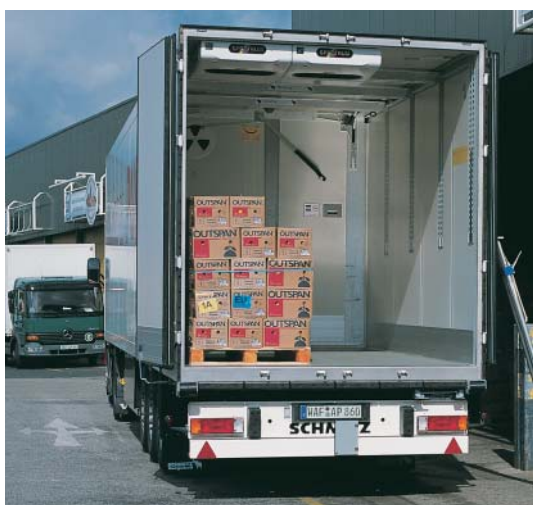
Fig. 14 Strutture per camion refrigerati: pannelli compositi con inserto in STYROFOAM. Ottimo isolamento termico ed elevata resistenza meccanica.
