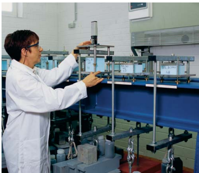
Fig. 10 Prova di resistenza a compressione a lungo termine (creep) sullo STYROFOAM nei laboratori DOW
