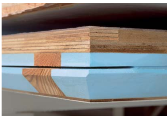
Fig. 15 Dettaglio di un pavimento di camion refrigerato
